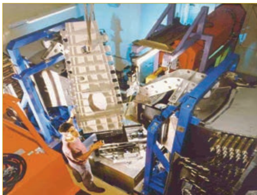
Figura 7: Posicionamiento de una pieza de Airbus en el instrumento ENGIN-X de la fuente ISIS.
