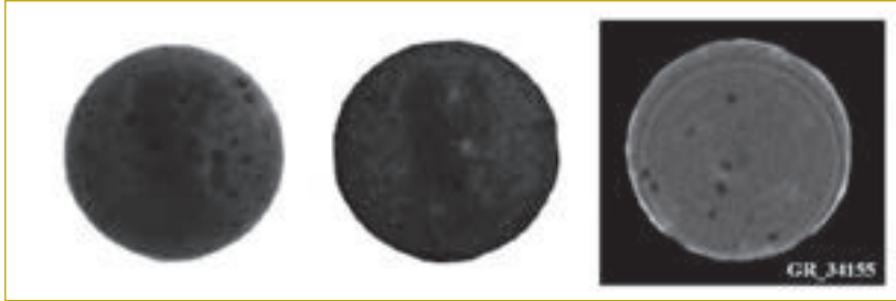
Figura 4: Imagen de una moneda de cobre de la Grecia clásica mediante rayos X (izquierda) y neutrones (centro y derecha) [2].
